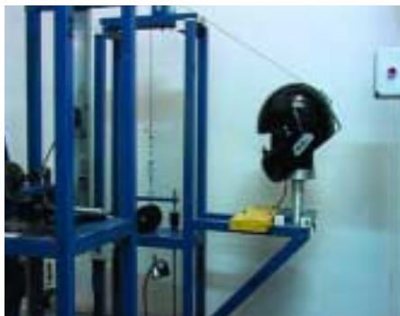
Prueba de descalce
