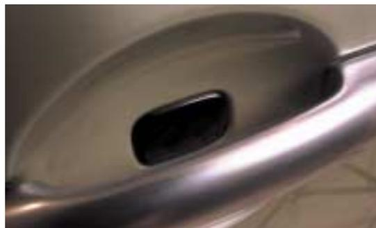
rá a través de una antena con la unidad de control electrónico (U.C.E.) y procederá al reconocimiento de la señal. De ser correcta dicha señal pasará a activar el sistema de apertura, y cuando la persona en cuestión introduzca la mano en el tirador de la puerta el vehículo se abrirá, ya que en las manillas se encuentran instalados los sensores de detección de proximidad, en este caso de la mano para abrir la puerta totalmente.
