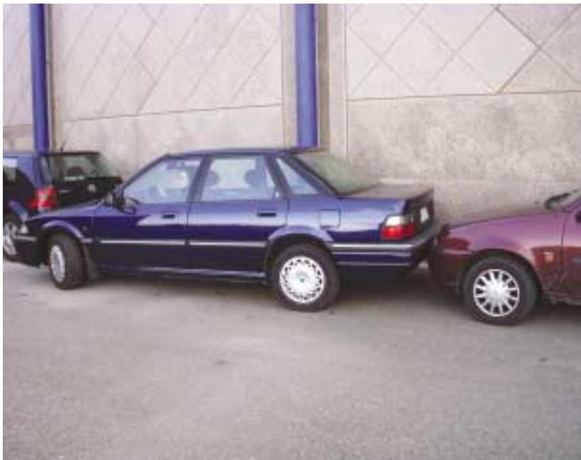
Uno de los parámetros de interés de los materiales plásticos, es la temperatura de transición vítrea ( $T_g$ ), temperatura a la cual el material pasa de tener un comportamiento frágil a dúctil. Este cambio se da en las regiones amorfas de los polímeros semicristalinos, materiales ampliamente utilizados en la fabricación de paragolpes de automóvil.
