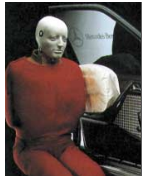
AIRBAG LATERAL PARA PROTECCIÓN DEL TORSO.
