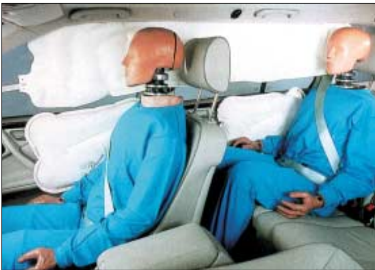
LOS AIRBAG DE CORTINA OFRECEN PROTECCIÓN A LA CABEZA EN COLISIONES LATERALES. ENTRE FRONTALES Y LATERALES UN VEHÍCULO PUEDE SUMAR HASTA OCHO AIRBAGS EN UN MISMO HABITÁCULO.
