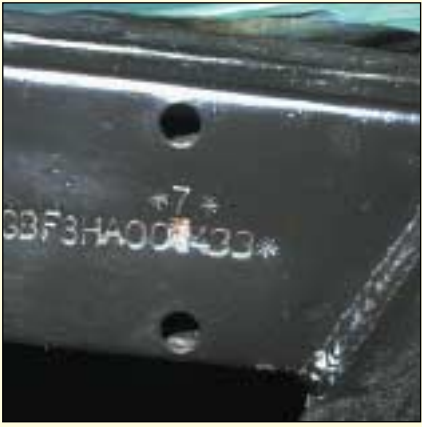
DIVERSOS EJEMPLOS DE MANIPULACIONES Y ALTERACIONES DEL TROQUELADO DE LOS NÚMEROS DE BASTIDOR: (1) RECORTADO DEL NÚMERO VIN, (2) TRANSFORMACIÓN DE UN NÚMERO DEL VIN, (3) RETROQUELADO DE UN NÚMERO VIN COMPLETO.
