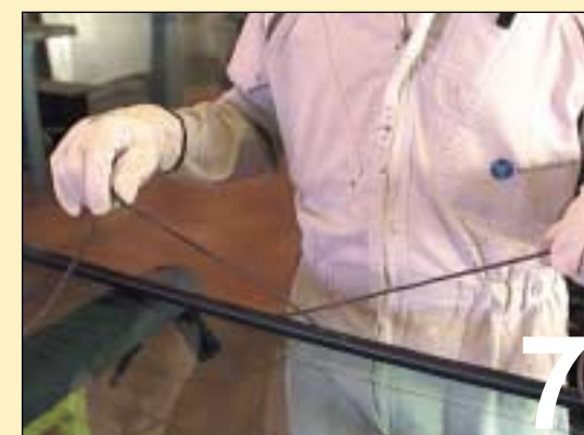
7 CRUZADO DE 15 CM DE LOS EXTREMOS DE LA CUERDA, EN LA PARTE INFERIOR
