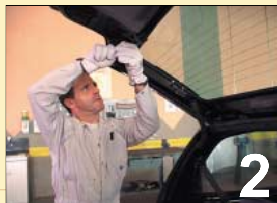
2 DESMONTAJE DE ACCESORIOS QUE IMPIDEN LA SALIDA DE LA LUNA
