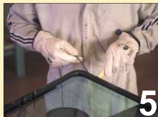
5 INTRODUCIR UNA CUERDA A LO LARGO DE LA OTRA RANURA DE LA GOMA
