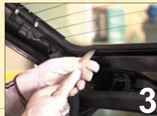
3 DESENCAJAR LA GOMA DE CONTORNO DE LA PATILLA DE LA CARROCERÍA
