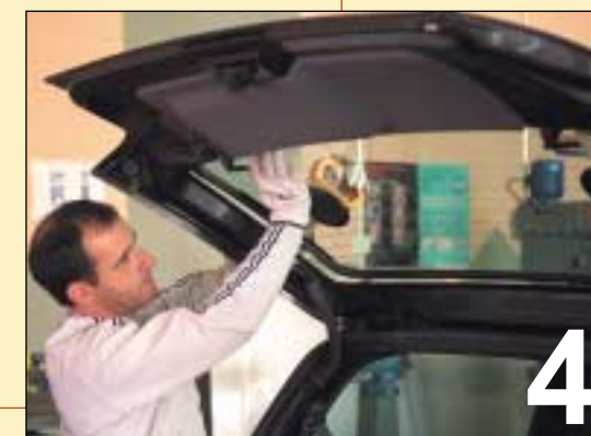
4 PRESIONAR LA LUNA HASTA DESENCAJARLA DE LA CARROCERÍA
