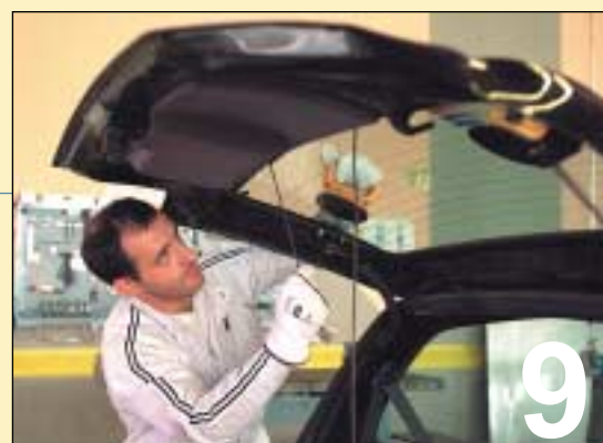
9 TIRAR DE LA CUERDA Y PRESIONAR SOBRE LA LUNA
