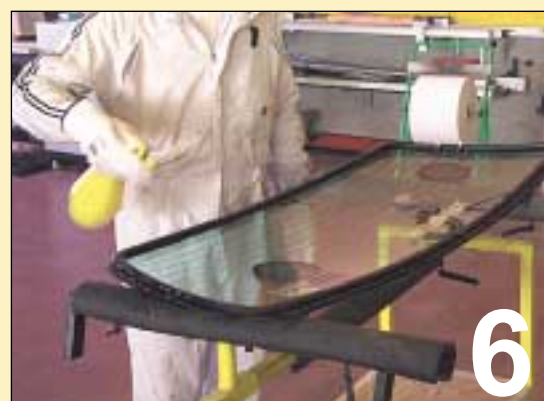
6 APLICACIÓN DE AGUA CON JABÓN A LAS RANURAS DE LA GOMA
