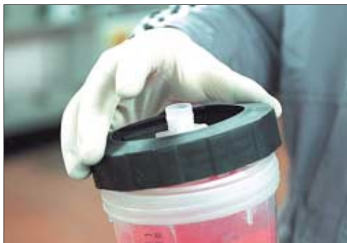
CIERRE DEL VASO DE MEZCLA QUE LO CONVERTIRÁ EN CAZOLETA DE LA PISTOLA AEROGRAFICA.
