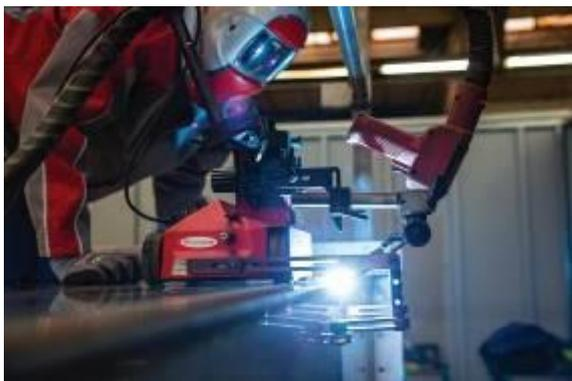
**Imagen 2:** El carro de soldadura ArcRover 22 con raíles guía durante la soldadura de cordón longitudinal.
