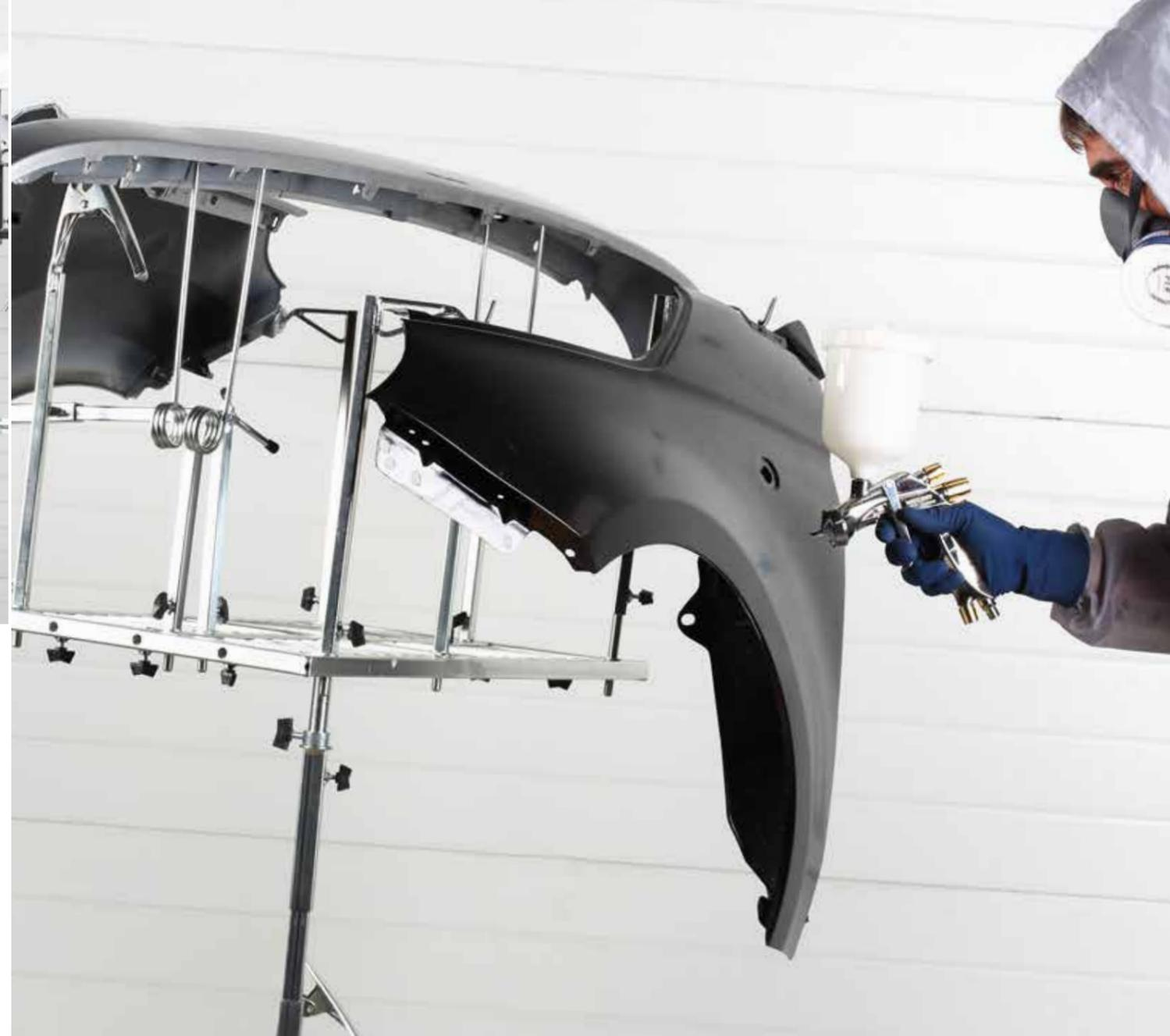
Para el pintado de grandes parachoques , el eje central nos permite subir la superficie base hasta una altura de 1'10 metros y situar el parachoques en una posición cómoda incluso para el pintado de las puntas de los mismos.
