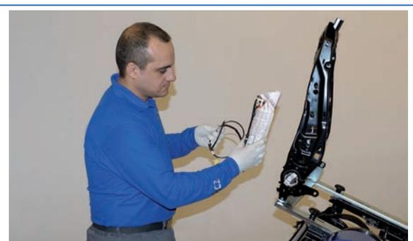
**10** Desmontaje del airbag lateral. (\*)
