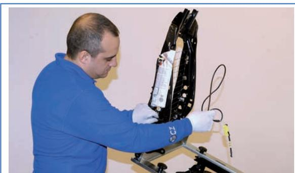
**9** Separación del mazo de cables.
