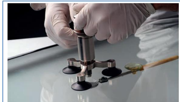
**4** Colocar el cilindro inyector de la resina de reparación.
