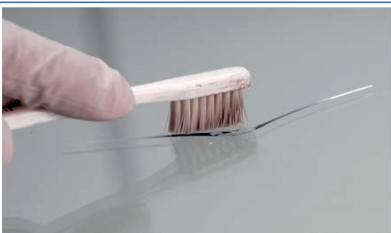
**3** Limpiar el daño, retirando los restos de vidrio que hayan podido quedar en la zona interior del impacto.
