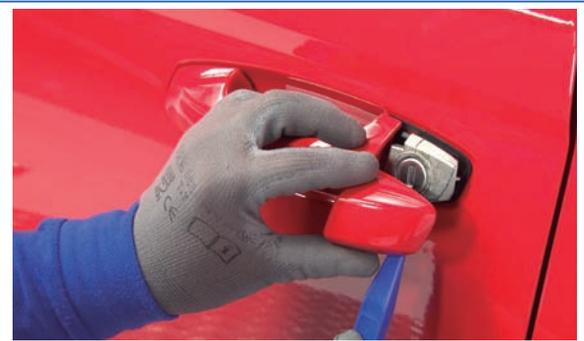
**6** Extraer la tapa del bombín con una palanca de teflón.
