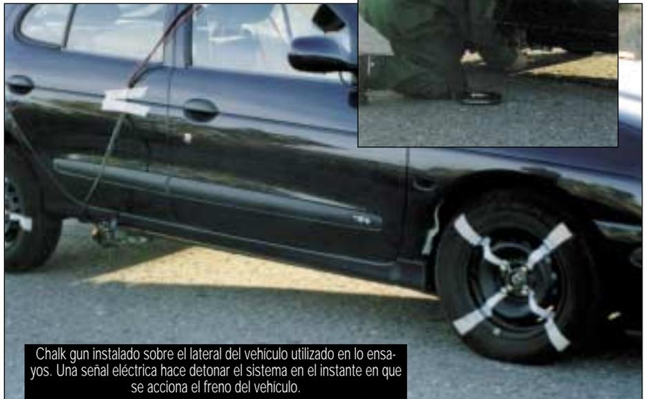
Chalk gun instalado sobre el lateral del vehículo utilizado en los ensayos. Una señal eléctrica hace detonar el sistema en el instante en que se acciona el freno del vehículo.
