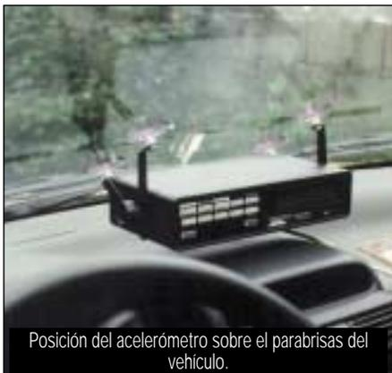
Posición del acelerómetro sobre el parabrisas del vehículo.
