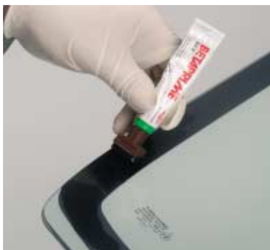
APLICACIÓN BETAPRIME 5005 SOBRE EL VIDRIO
