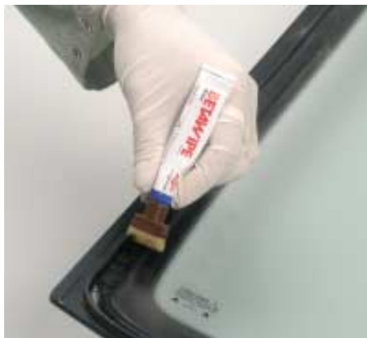
APLICACIÓN DE BETAWIPE 4004 SOBRE POLIURETANO
